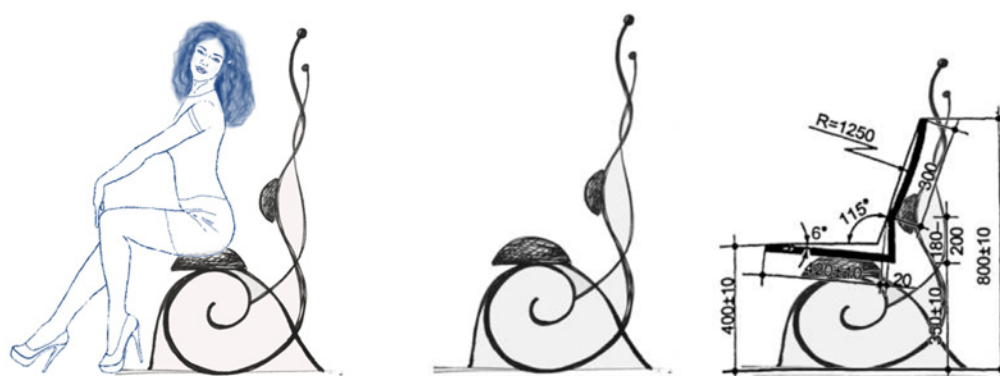
Рис. 5. Графическое моделирование профиля линии Акерблома применительно к авторскому стулу
