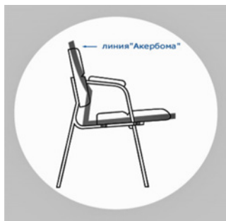
Рис. 3. Стул для работы, схема профиля стула по Б. Акерблomu
